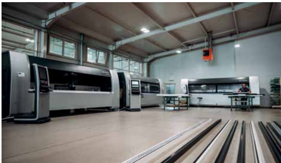
Die Aluminium-Haustüren werden bei Eutherm auf modernen Schüco-Stab-Bearbeitungsmaschinen hergestellt.
