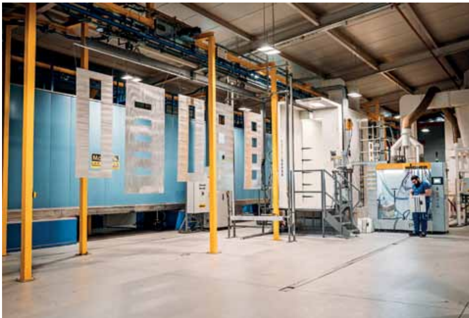
Mit der Pulverbeschichtungsanlage PXM von Wagner konnten die Kapazitäten deutlich gesteigert werden.
