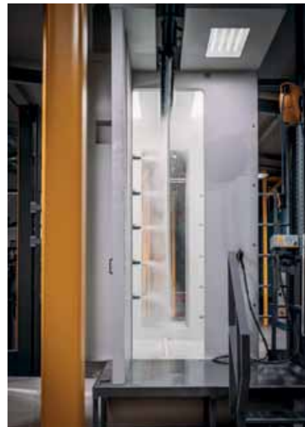
Die Pulverbeschichtung findet vollautomatisiert statt.
