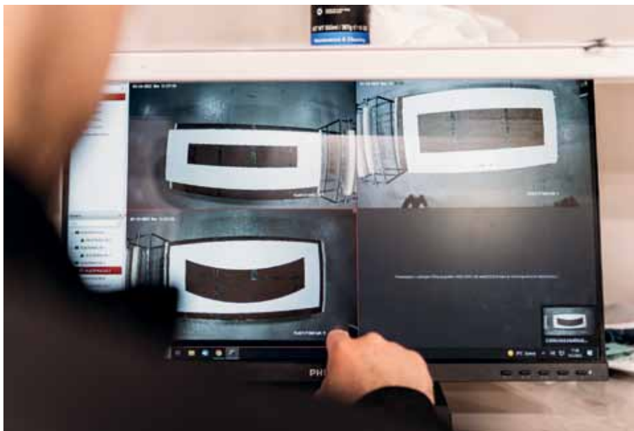
Eine Kamera über dem Ablagetisch fotografiert jedes Deckblech und speichert es digital ab.
